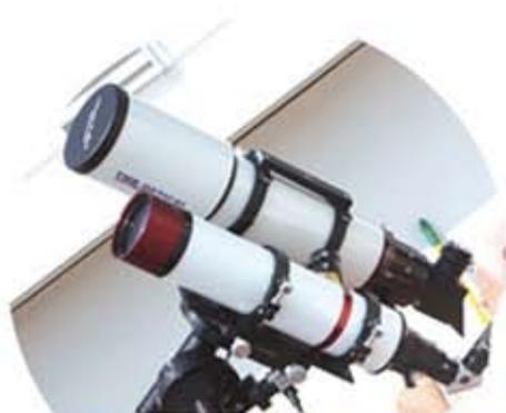
**Il nuovo Telescopio Solare in "setup" (due in parallelo), uno dei più grandi in Puglia, per osservare tanti dettagli del Sole, come protuberanze e macchie solari, nella totale sicurezza**
